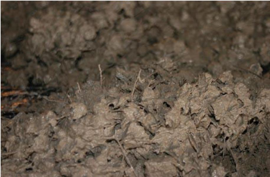
**FIGURA 56:** Fibras metálicas adicionadas ao concreto em piso.
