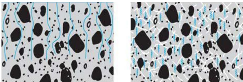
**FIGURA 58:** Mecanismo de ação das fibras de polipropileno no controle da exsudação em piso de concreto. Fonte: Fitesa/ LPE Engenharia e Consultoria
