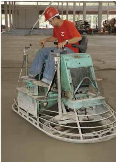
**FIGURA 67:** Alisadora dupla de alta rotação com disco de flotação para argamassamento da superfície.
