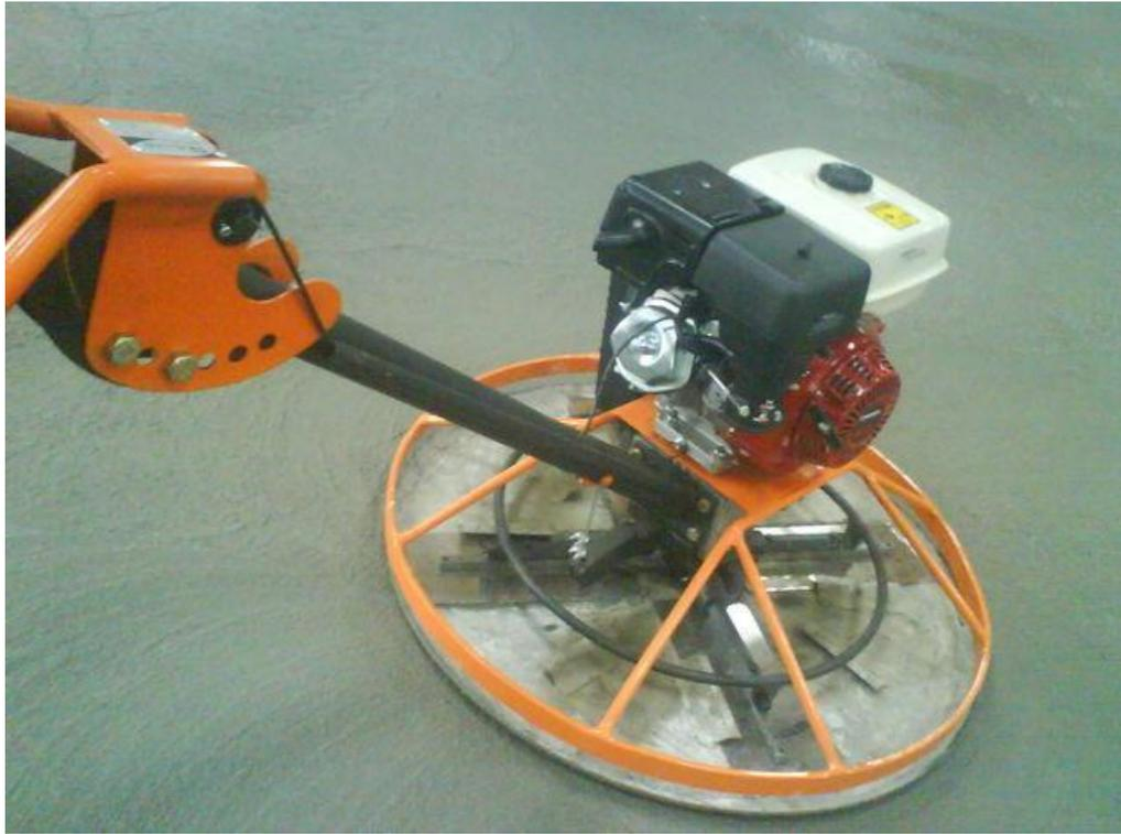
**FIGURA 66:** Acabadora mecânica. Fonte. Portal PI – Piso Industrial
