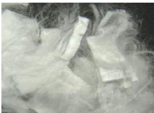
**FIGURA 57:** Fibras de polipropileno. Fonte: FibroMac
