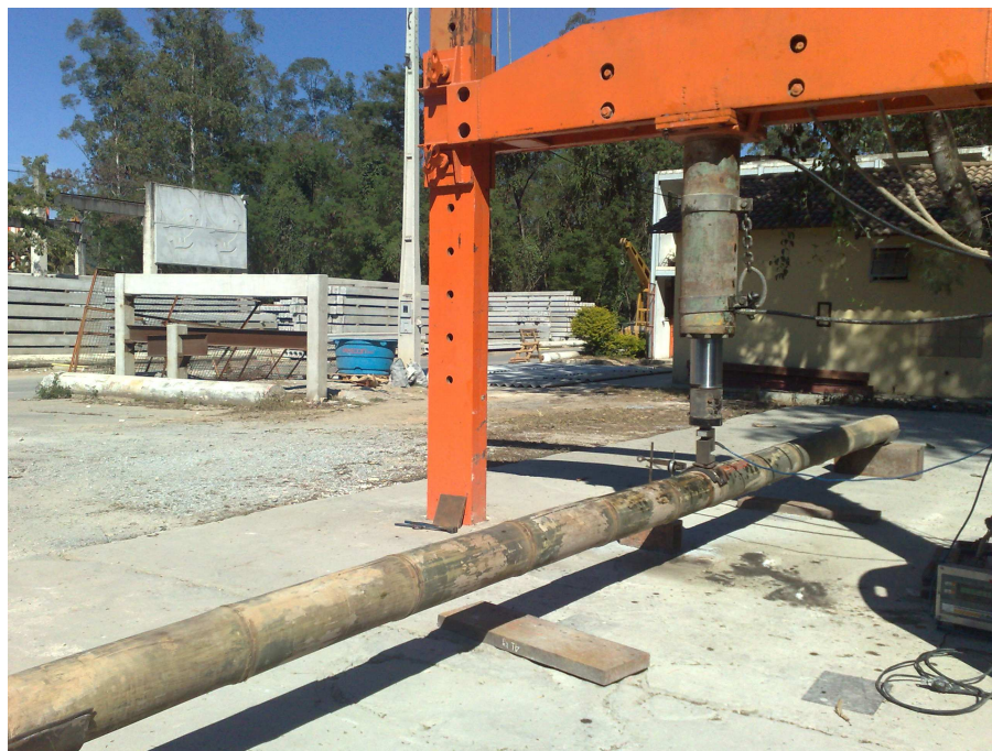
Figura 3.2: Prensa hidráulica para aplicação de carga na viga
