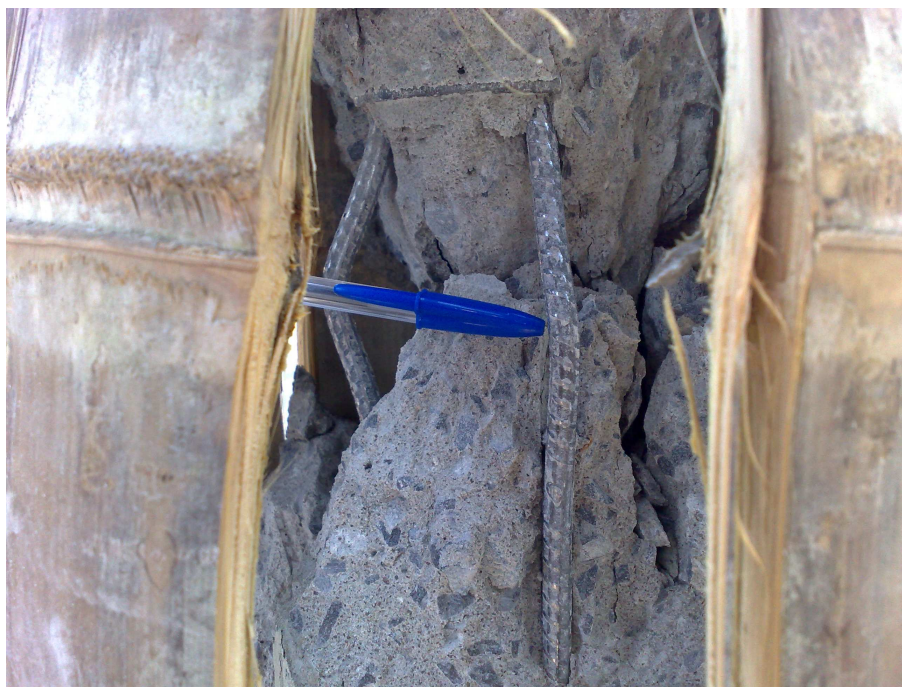
Figura 4.4: Detalhe da ruptura no pilar, as fibras do bambu romperam-se longitudinalmente
