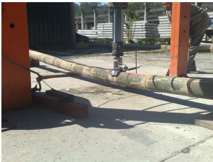
Figura 4.1: : Deformação da viga ocasionada pela aplicação de carga, deformação máxima de 209mm
