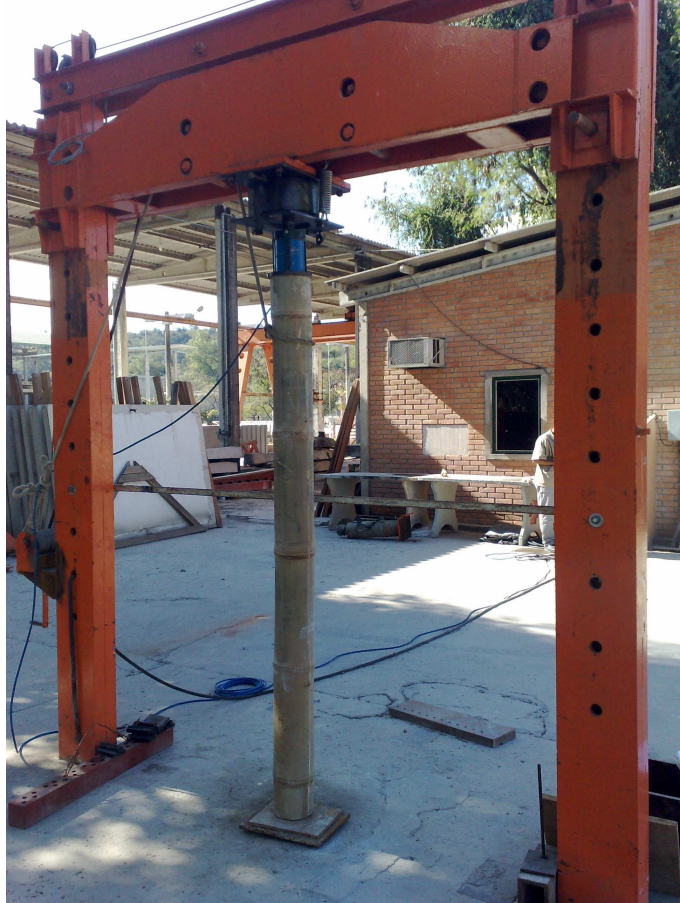
Figura 3.4: Prensa hidráulica para aplicação de carga no pilar, carga máxima de 42,6MPa
