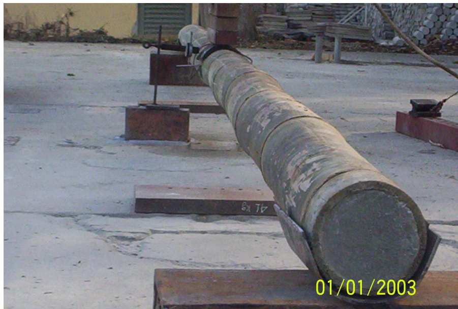
Figura 3.1: Viga de bambu preenchida com microconcreto e apoios metálicos
