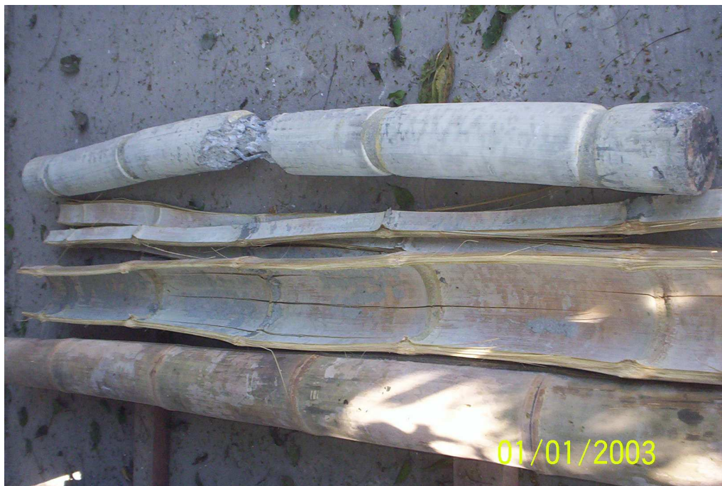
Figura 4.2: Viga de bambucon rompida com carga de 189,1Kgf
