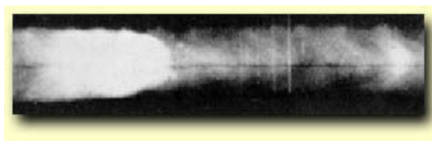
Figura 61 – Exemplo de falta de penetração
