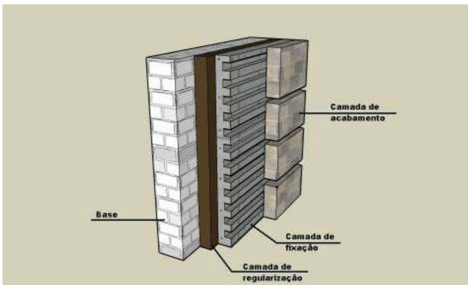
FIG.2- SISTEMA REVESTIMENTO FACHADA-(fonte CCB- [www.ccb.org.br](http://www.ccb.org.br))
