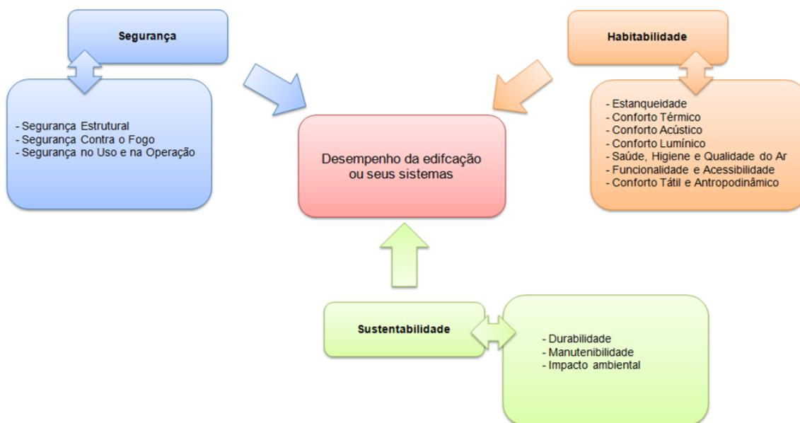
**Figura 9:** Exigências do Usuário NBR 15575. (adaptado pelo autor)
