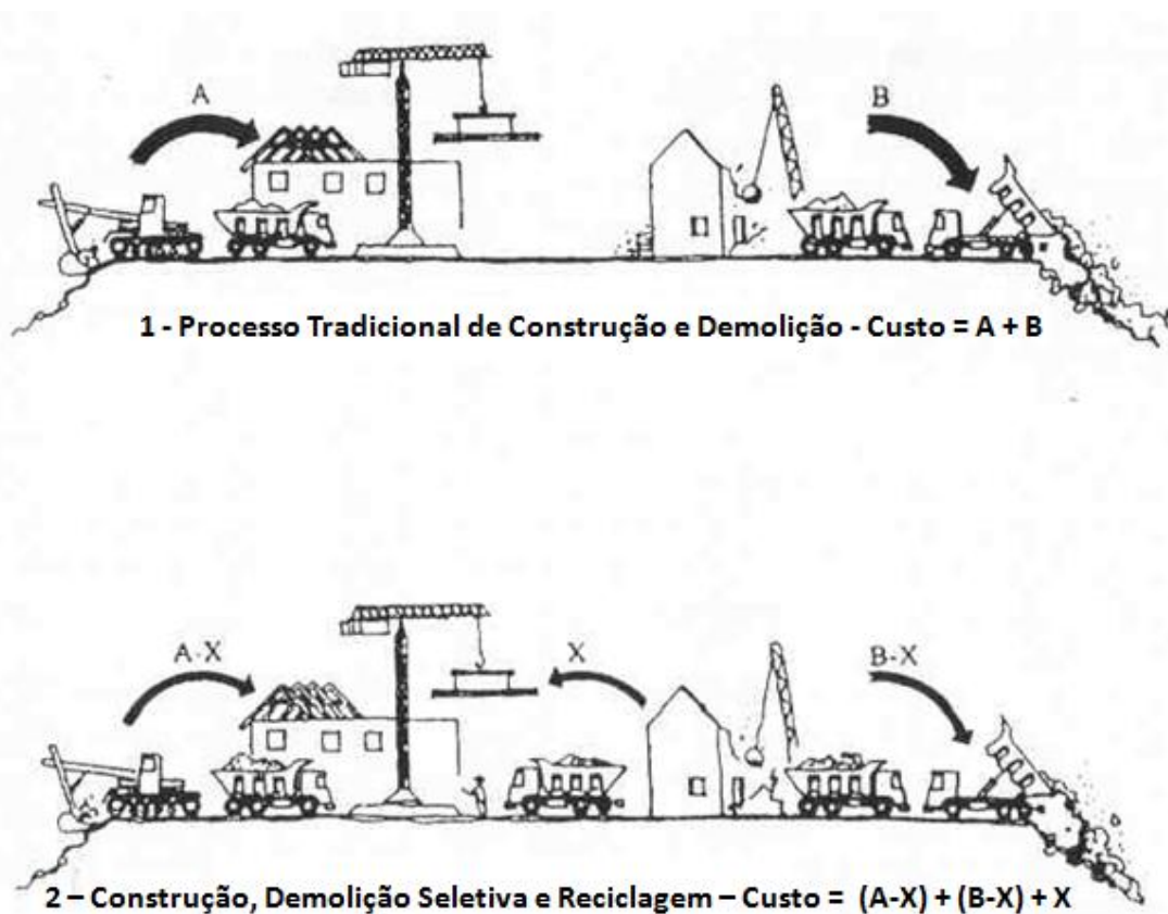
Figura 3 – Demolição seletiva e redução de custo de obra (Modificado) - HENDRIKS (4)
