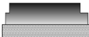
**Figura 47: Detalhe de duas demãos aderentes de tintas**
