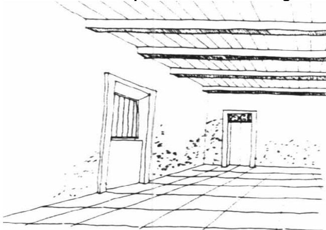
Figura 3.10 – Manchas devido ao surgimento de microorganismos. Fonte: Manual de conservação preventiva para edificações.
