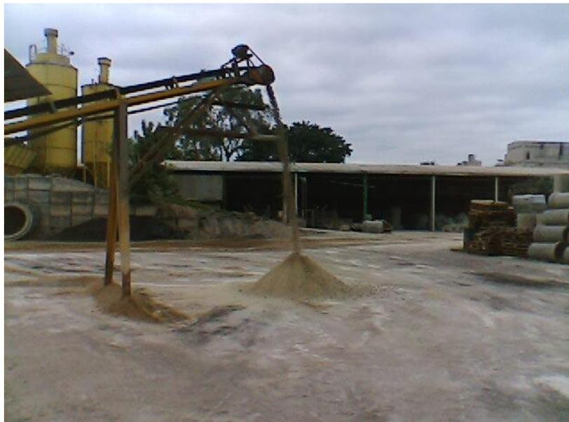
**Figura 5: Agregado reciclado após ser britado e peneirado**
