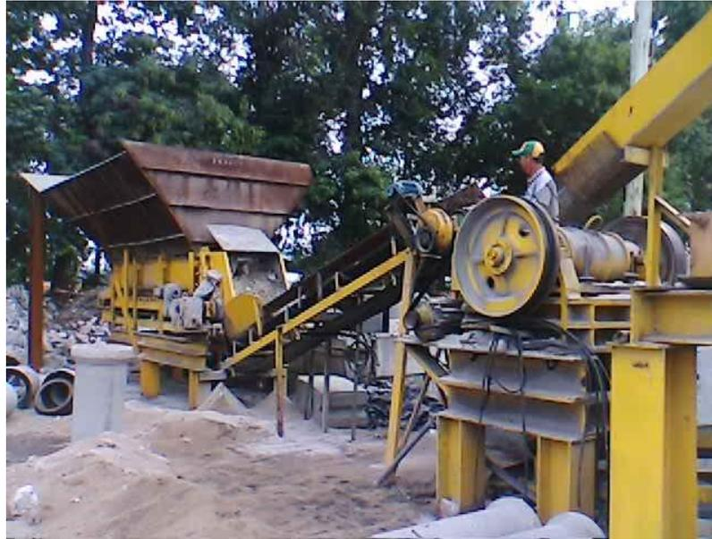
**Figura 4: Linha de britagem instalada na central de concreto da Pedreira Um Valemix de Santana do Paraíso – MG.**
