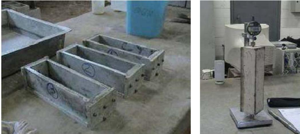
Figura 3.12 – Moldes e sistema de leituras empregados no método CPT (SANCHEZ (2008)).
