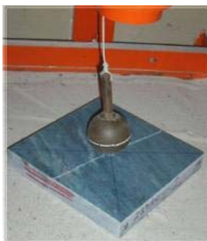
Figura 06: Detalhe de corpo de prova quebrado pela queda da esfera de aço.
