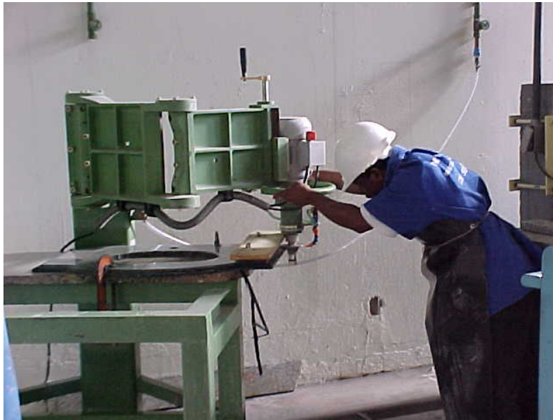
Figura 44: Acabamento manual com fresa de bancada.
