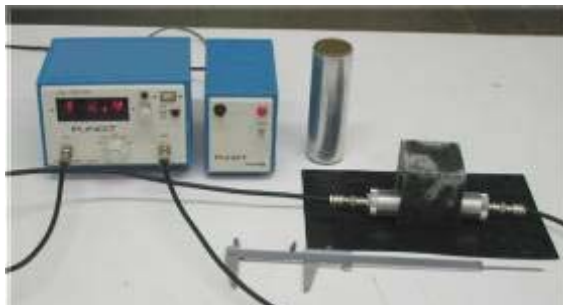
Figura 08: Ilustração da medida de velocidade de propagação de ondas.
