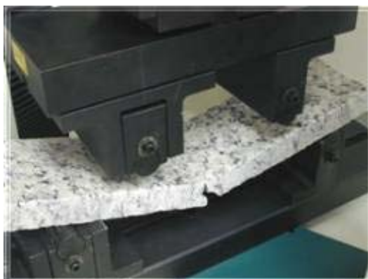
Figura 07: Detalhe de corpo de prova, obtido a partir de rocha beneficiada, rompido após aplicação de esforços.
