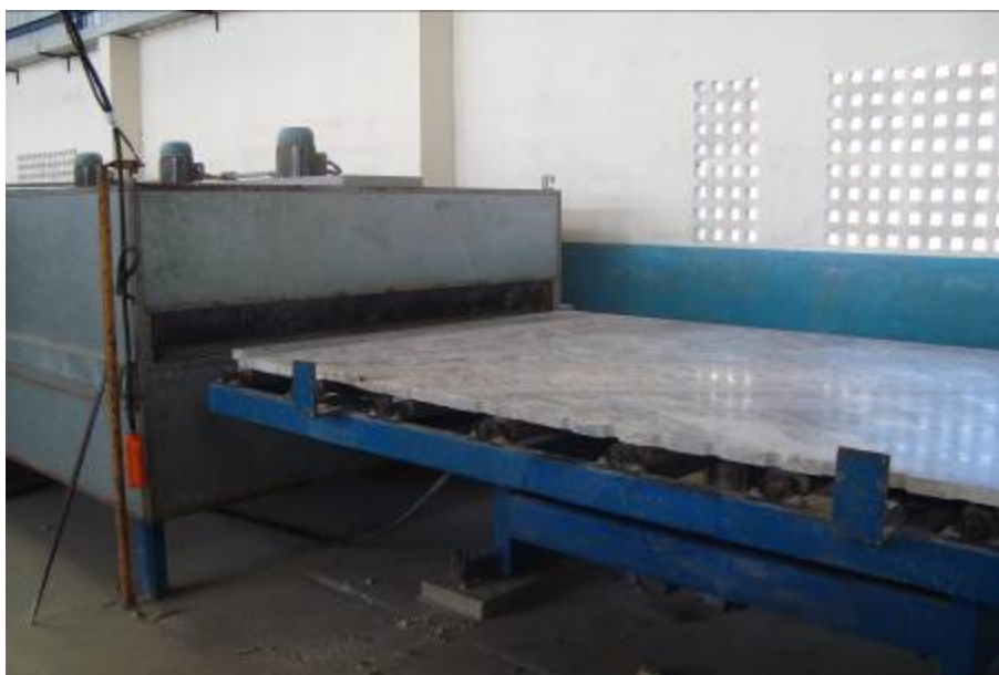
Figura 25: Material levigado pronto para entrar no forno onde será aquecido à 700°C.
