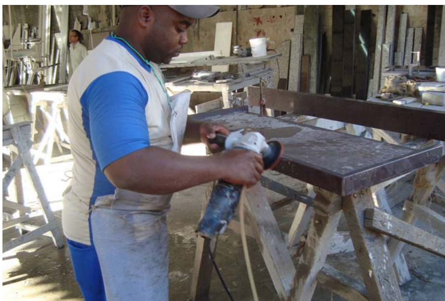
Figura 43: Politriz, segundo processo do acabamento manual.
