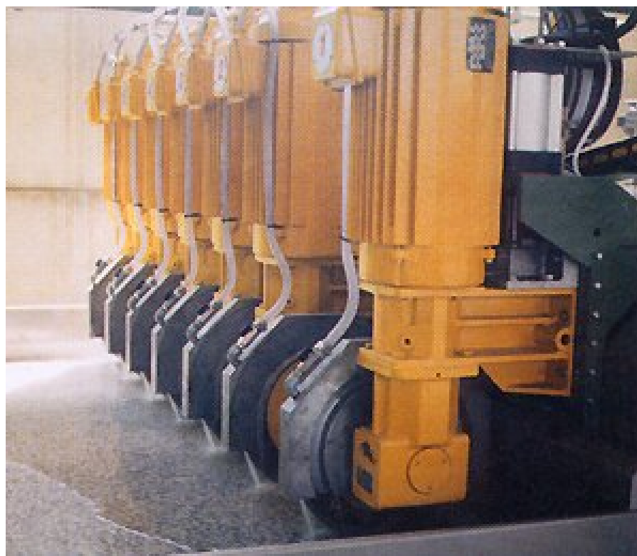
Figura 37: Linhas automáticas para peças padronizadas (pisos padrões).
