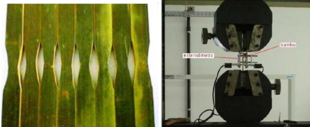
Figura 24: Corpos de prova e Ensaio à tração do bambu (Fonte: Nunes, 2005)
