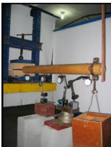
Figura 25 : Ensaio à flexão em uma amostra de Bambu (Fonte: Nunes, 2005)
