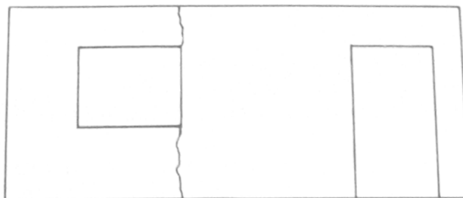
Fissura 3.69 – Fissura de retração em parede monolítica de concreto, na seção enfraquecida pela presença do vão da janela
