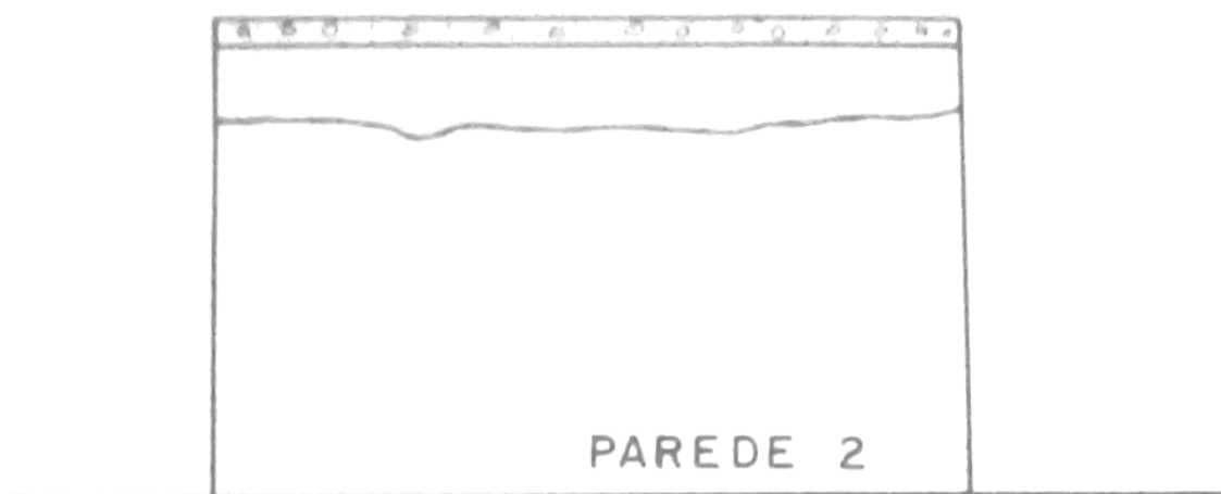
Figura 3.6 – Trinca típica presente no topo da parede paralela à largura da laje (Fonte: THOMAZ)
