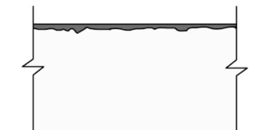
Figura 3.25 – Destacamento da argamassa no topo do muro. (Fonte: THOMAZ)
