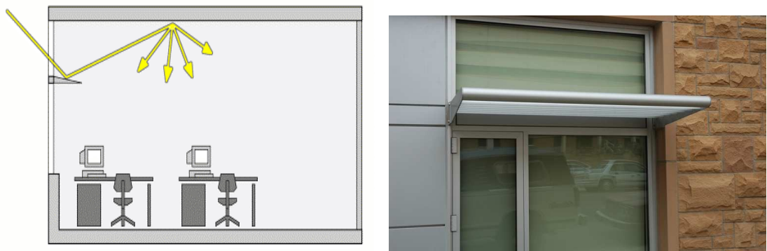
Figura 06 – Figura esquemática e foto de uma janela com light shelf
