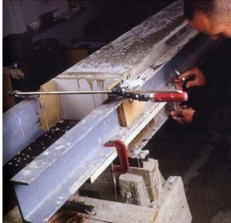
Foto 2.46: Concreto translúcido - processamento
