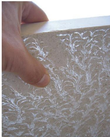
Foto 2.47: Nesse método de confecção, como não há fixação da posição das fibras, embora dispostas paralelamente no molde durante o processo de produção, no bloco aparentam dispersão orgânica na massa do concreto.
