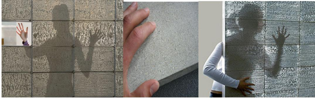
Foto 2.43: concreto transmissor de luz - Litracon™
