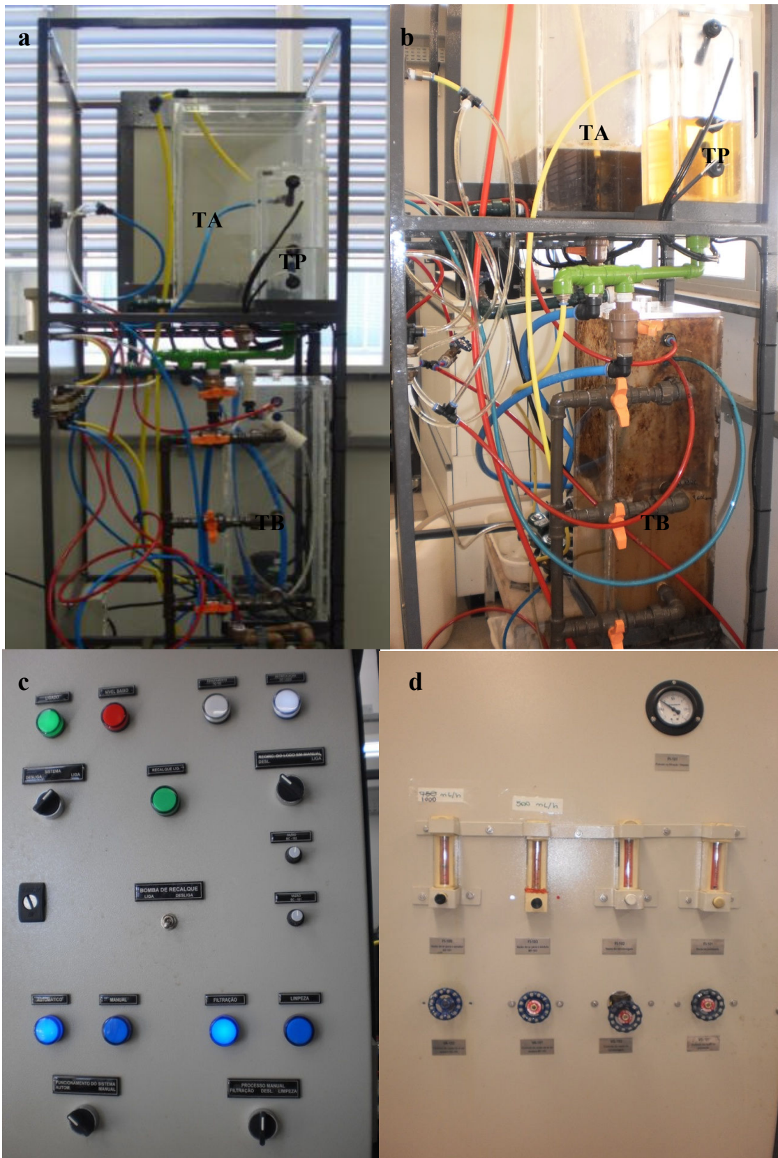
Figura 4.3: Fotografias do BRM utilizado. Legenda: a e b - vista lateral direita (TA - Tanque de Alimentação, TP – Tanque de Permeado, TB – Tanque Biológico aeróbio); c - skid com o painel elétrico; d – vista frontal.
