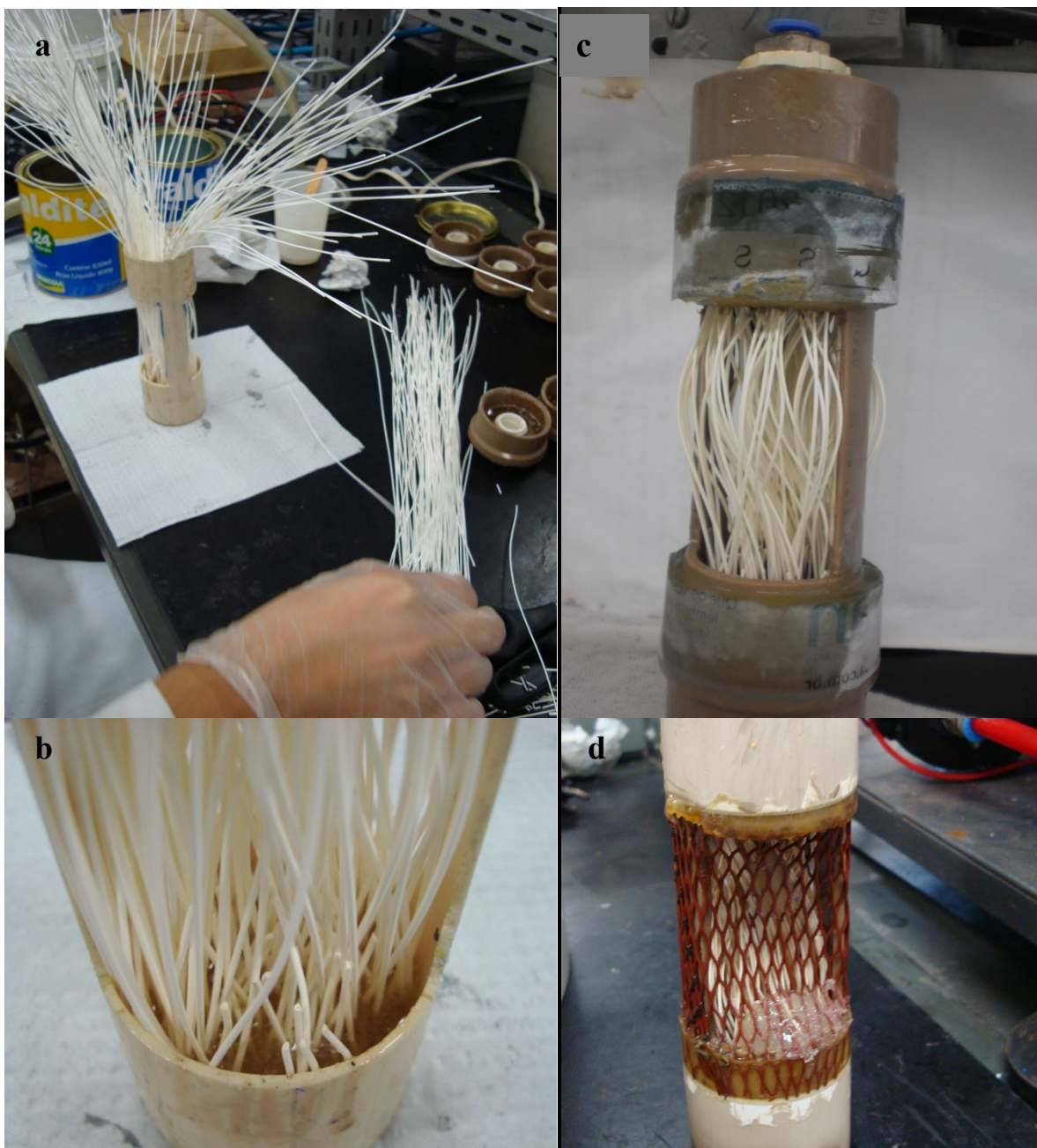
Figura 4.4: Fotografias do módulo e da sua montagem. Legenda: a - montagem do módulo em conformação de feixes; b - detalhe das fibras aeradoras; c - módulo pronto; d - rede protetora.
