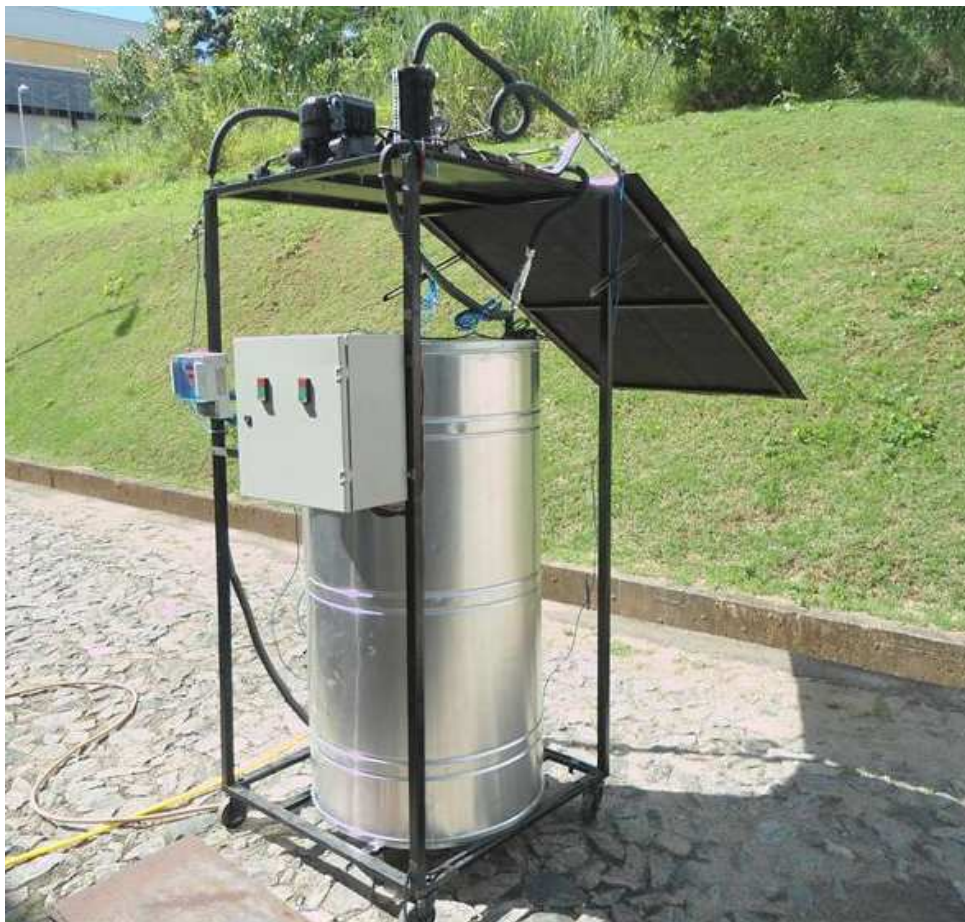
Figura 3.12 –Protótipo da bomba de calor com destaque para a caixa de comando
