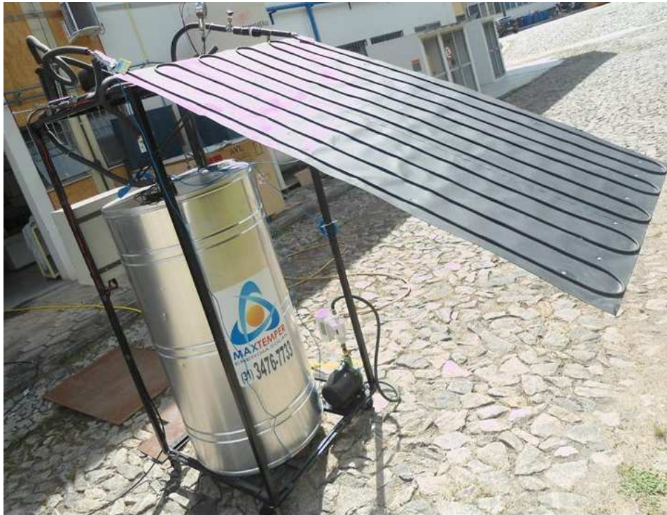
Figura 3.11 –Protótipo da bomba de calor com destaque para o evaporador
