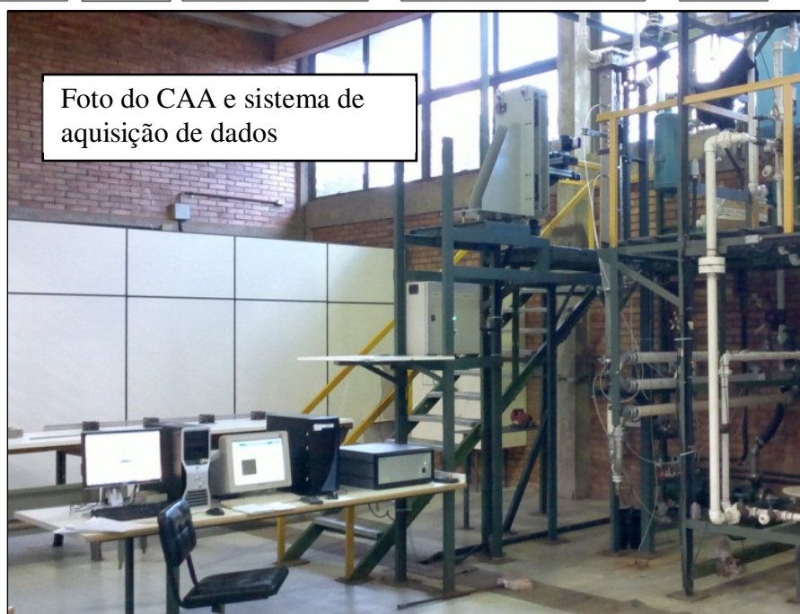
Figura 3.1 – Circuito Água-Ar (CAA) usado nos testes fluidodinâmicos com água.
