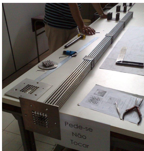
Figura 3.6 – Montagem do feixe de varetas com grade espaçadora concluída na bancada.
