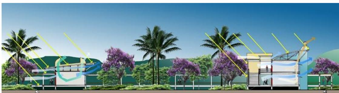
FIGURA 3.4 – Esquema de ventilação do edifício.
