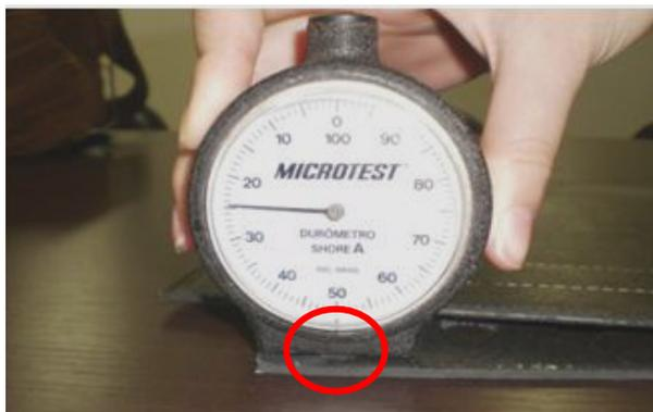
Figura 4.10 Determinação da dureza “Shore” A.
