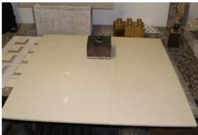
Figura 4.30 Assentamento de placa de porcelanato sobre placa porcelanato (“retrofit”).
