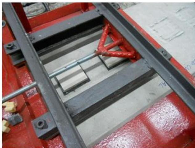
Figura 4.34 Aparelho desenvolvido para ensaio de cisalhamento.
