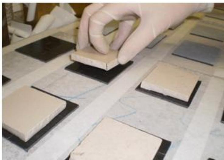
Figura 4.27 Assentamento da manta adesiva após 30 minutos da retirada do adesivo.
