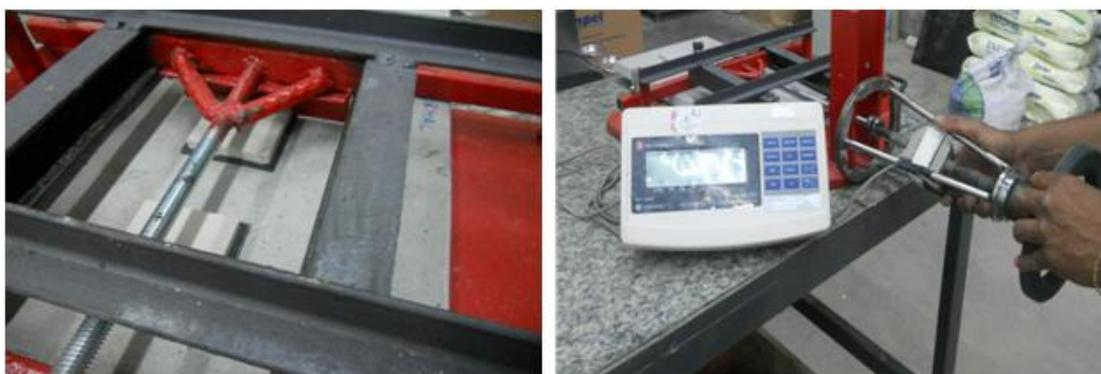
Figura 5.99 Vista do equipamento de ensaio de resistência ao cisalhamento direto.
