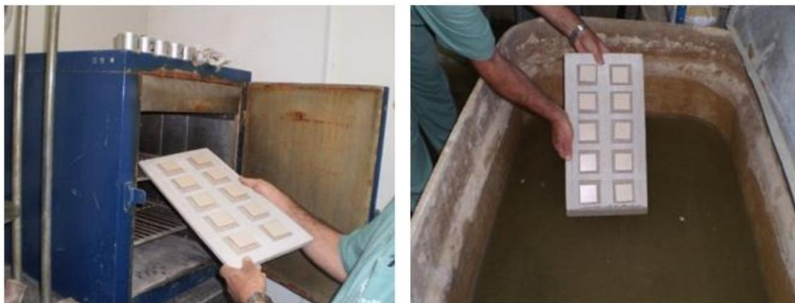
Figura 4.31 Ciclos de secagem e molhagem da argamassa colante.
