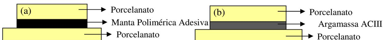
Figura 4.20 Representação esquemática dos sistemas montados sobre porcelanato (ensaio sobre o “retrofit”) (a) Assentamento utilizando a manta polimérica adesiva (b) Assentamento utilizando a argamassa ACIII.
