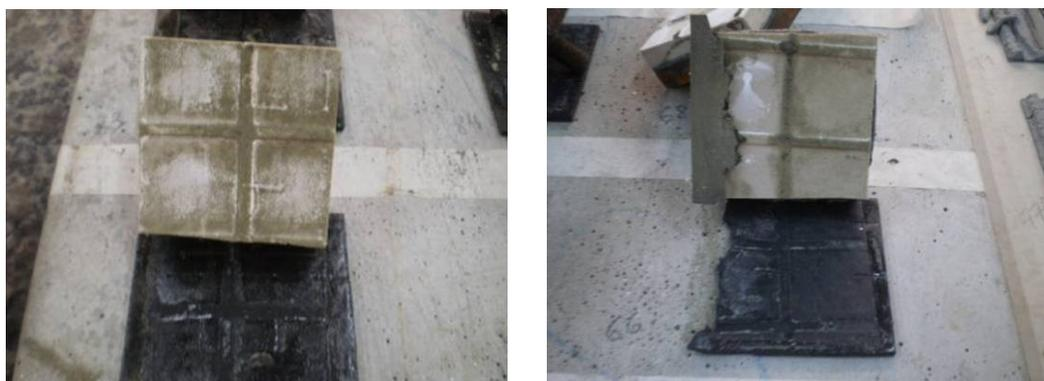
Figura 4.26 Placa com contato de adesivo da manta utilizada e a verificação da impregnação do pó.
