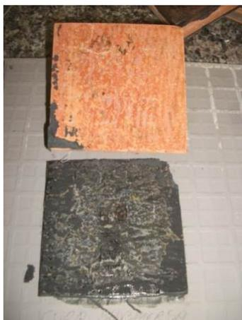
Figura 5.106 Ruptura da manta aderida ao substrato.
