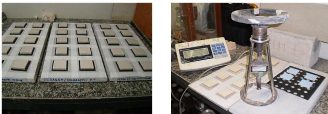
Figura 4.21 Ensaio realizado com a cura normal e aparelho de arrancamento.
