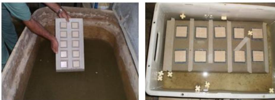
Figura 4.22 Ensaio de cura submersa em água.
