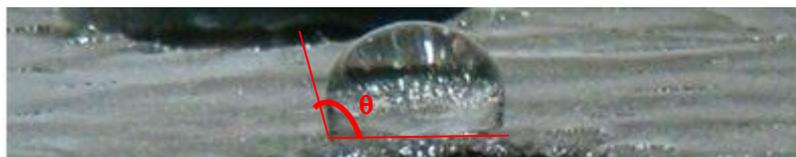
Figura 5.12 Ângulo de contato na manta adesiva.
