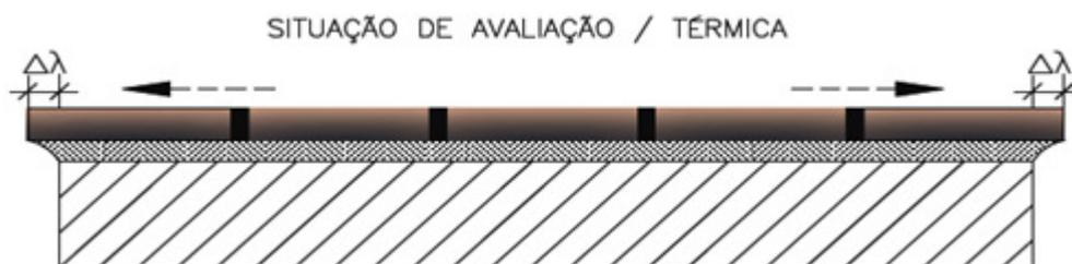
Figura 4.42 Croqui esquemático dos deslocamentos gerados na situação de variação térmica.
