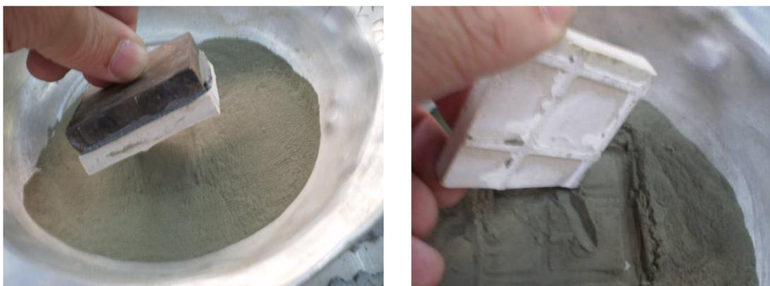
Figura 4.25 Placa sem uso e a verificação da não impregnação do pó.
