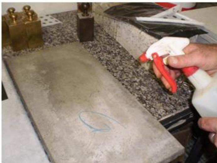
Figura 4.28 Saturação da base para assentamento das placas cerâmicas.
