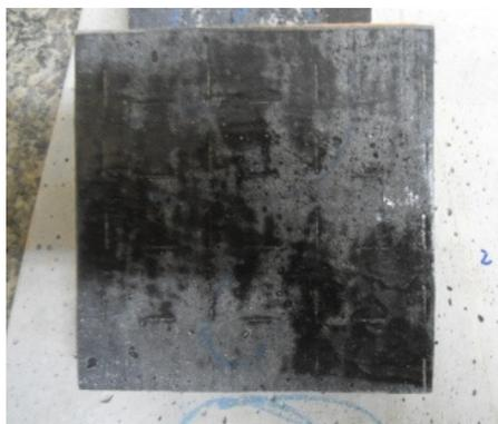
Figura 5.103 Ruptura quando submetido a cura normal.
