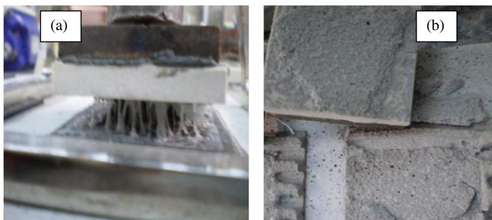
Figura 5.93 Ruptura quando submetido ao envelhecimento (a) Manta (b) ACIII.
