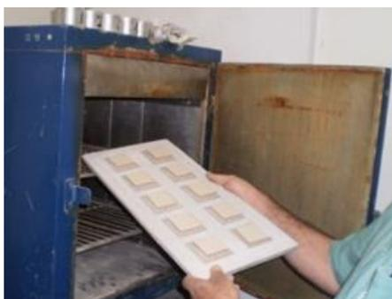
Figura 4.23 Ensaio de cura em estufa.
