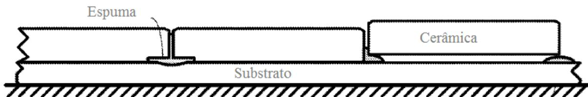
Figura 3.3 Representação esquemática do novo produto de assentamento.
