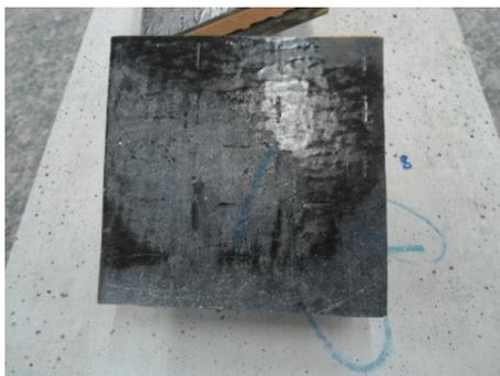
Figura 5.105 Ruptura quando submetido a cura em estufa.
