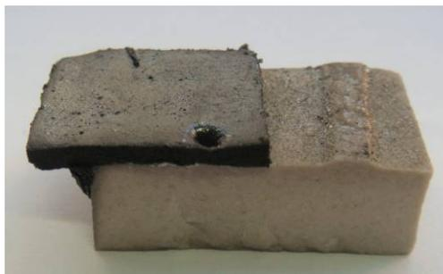
Figura 5.79 Amostra utilizada para a realização do MEV.
