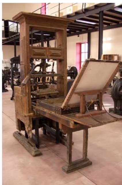
FIGURA 132 – Máquina de impressão Manual – Séculos XVI a XVIII Fonte: UM ESPÓLIO INDESEJÁVEL, 2011. 172
