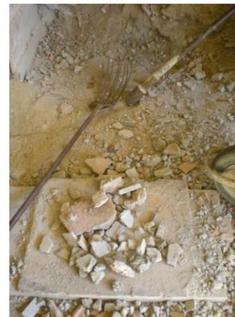
**FIGURA 3.12 – Plataforma de madeira e ferramentas manuais, pilão e garfo metálico para compactação e separação de resíduos.**
