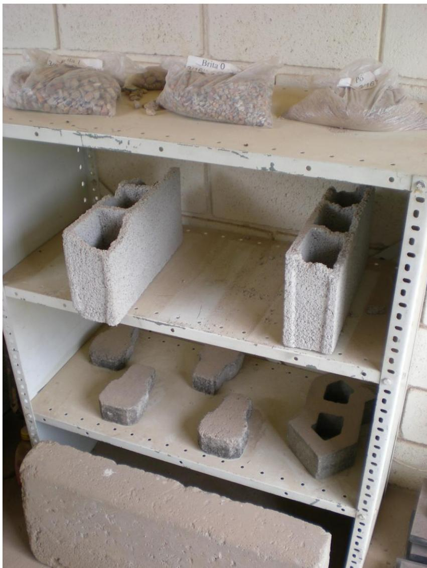
**FIGURA 2.2 - Modelos de Materiais fabricados com RCC Classe A após os processos de reciclagem.**
