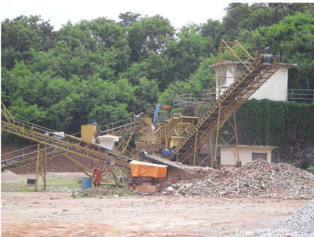
**FIGURA 2.1 - Máquina da PMBH para Reciclagem de RCC Classe A.**
