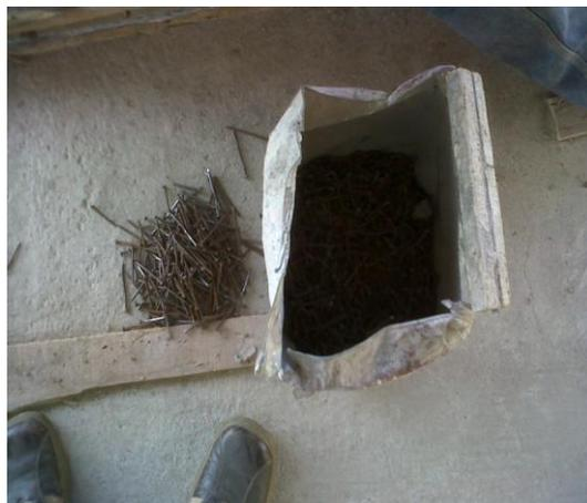
**FIGURA 3.20 – Armazenamento de pregos desamassados para reuso**
