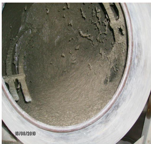
Figura 3.2: Mistura após colocar o superplastificante e modificador de Viscosidade do CAA
