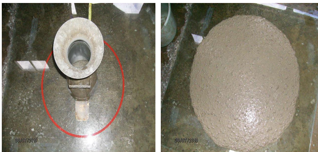
Figura 3.5: (a) Teste de espalhamento: início do ensaio slump flow test; (b) Término do ensaio slump flow test.
