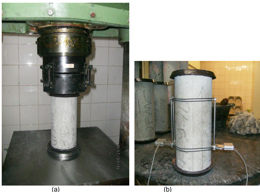
Figura 3.8: (a) Ensaio de Compressão Axial; (b) Ensaio de módulo de Elasticidade no laboratório da Holcim S/A.
