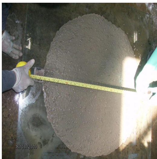
Figura 3.3: Medição do espalhamento após término do ensaio de slump flow test.
