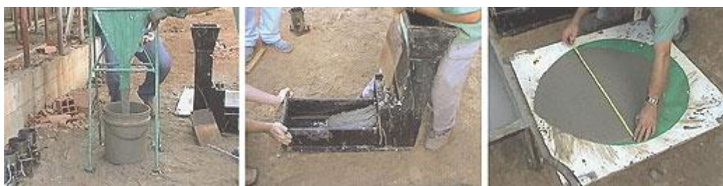
Figura 2.2: (a) Ensaio Funil V; (b) Ensaio caixa L; (c) Ensaio Slump Flow test. (Fonte: http://www.revistatechne.com.br/engenharia-civil/125/imprime59012.asp )
