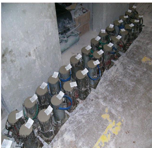
Figura 3.4: Moldagens dos corpos de prova cilíndricos após ensaios de caracterização do CAA.
