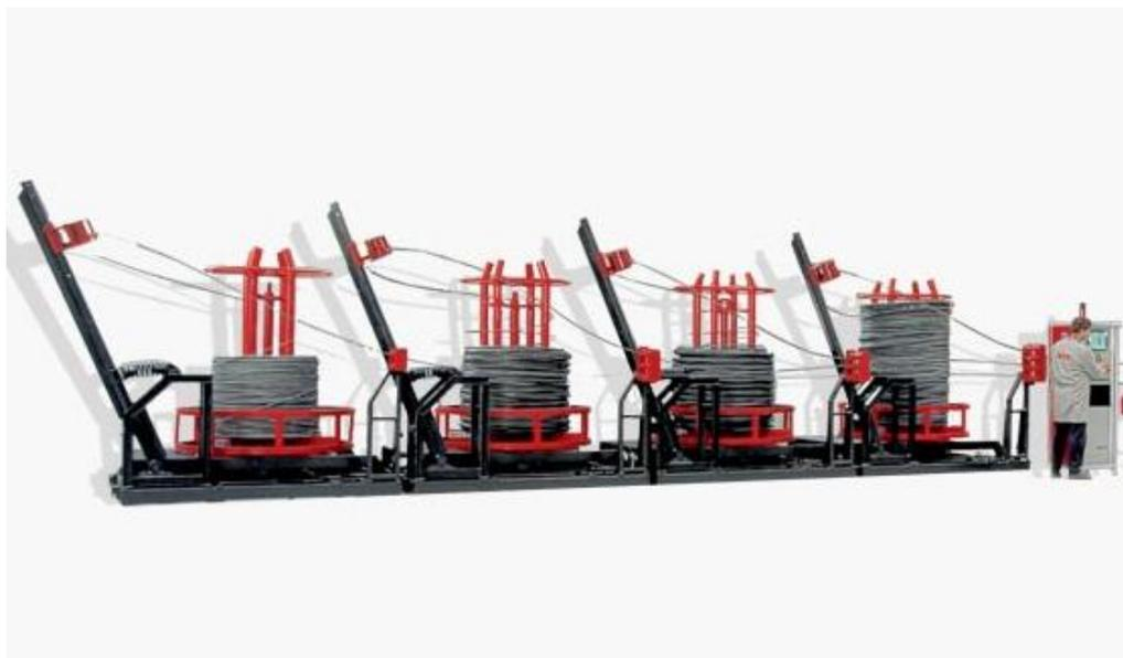
Fig.4.2 – Estocador de matéria-prima da Mini Syntax
