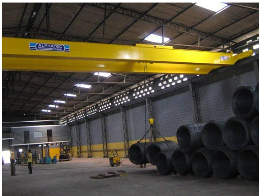
Fig.4.4 – Ponte rolante içando o rolo de matéria-prima para abastecimento da máquina
