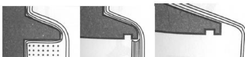
Figura 8: Efeitos dos ressaltos no escoamento da água de chuva - FONTE: UEMOTO, 2005
