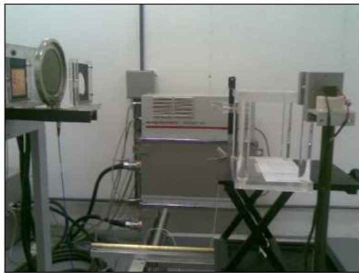
Figura 4.4: Posicionamento da câmara de ionização Radcal Corporation modelo RC6.
