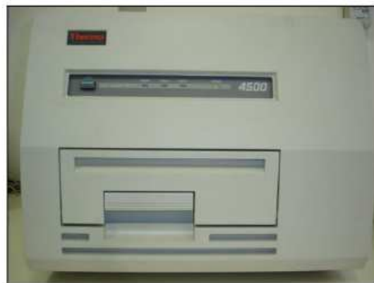
Figura 4.2: Leitora termoluminescente Harshaw, Thermo Electron Corporation, modelo: 4500.
