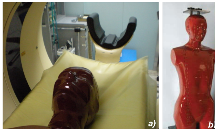
Figura 4.11: Objeto simulador Alderson Rando feminino, posicionado no tomógrafo(a) e vista completa do mesmo quando montado(b).
