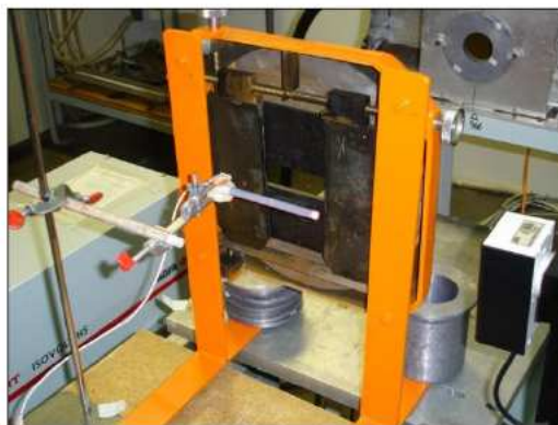
Figura 4.6: Posicionamento da câmara em relação ao colimador e a fonte de raios X.
