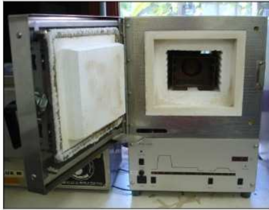
Figura 4.3: Forno automatizado PTW Freiburg modelo TLD O.
