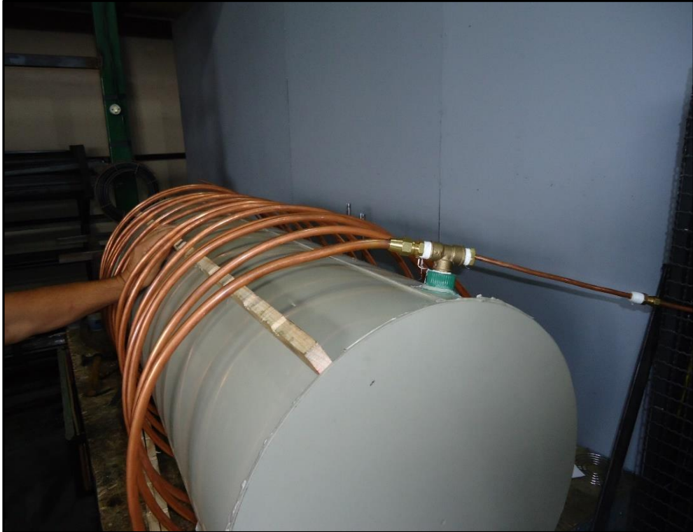
FIGURA 3.9 - Detalhes construtivos do resfriador de gás.
