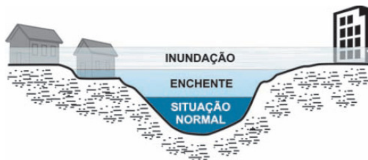
Figura 03: Perfil esquemático processo de enchente e inundação, Min. das cidades/IPT (2005)
