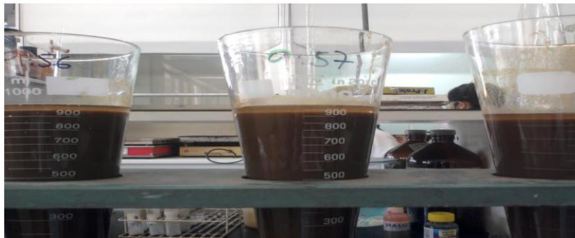
Figura 5.2: Sedimentação do lodo do decantador da estação de Itaguara
