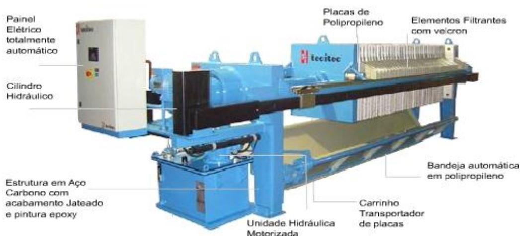
FIGURA 3.9: Representação do filtro prensa de placas
