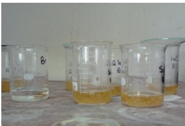
Figura 5.3: Digestão da amostra de lodo em chapa
