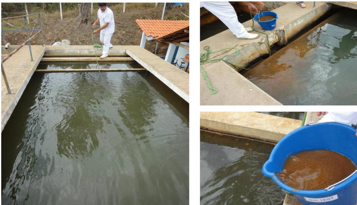
Figura 5.1: Coleta do lodo no decantador
