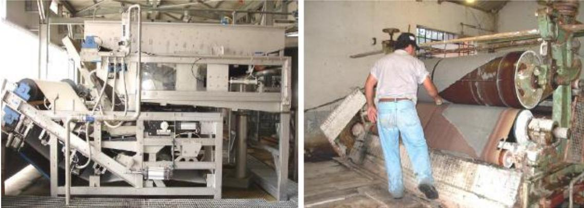
FIGURA 3.8: Prensa desaguadora
