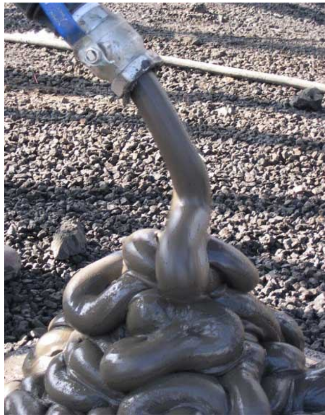
Figura 3.9: Aspecto da pasta oriunda de espessadores de alta densidade (WESTECH,2008).
