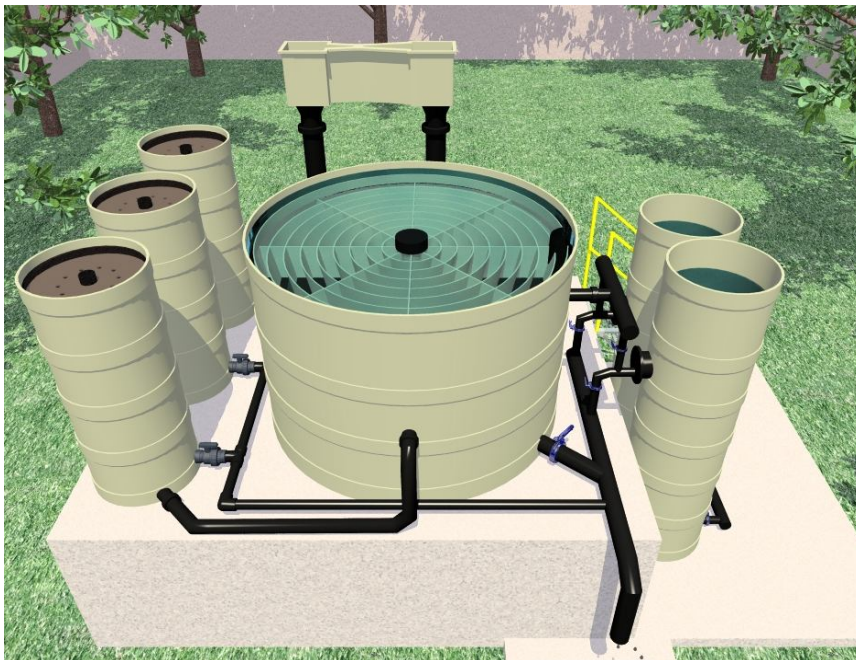
Figura 3.15: Vista em três dimensões de uma estação de água pré-fabricada (SANEAQUA, 2008).
