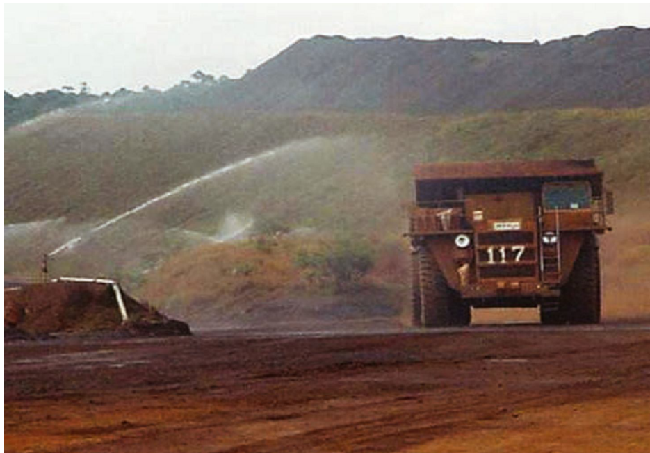
Figura 2.3: Sistema de aspersão automatizada em vias de acesso a Mina de Tamandúá – Minas Gerais, de propriedade da VALE (ANA, 2005)
