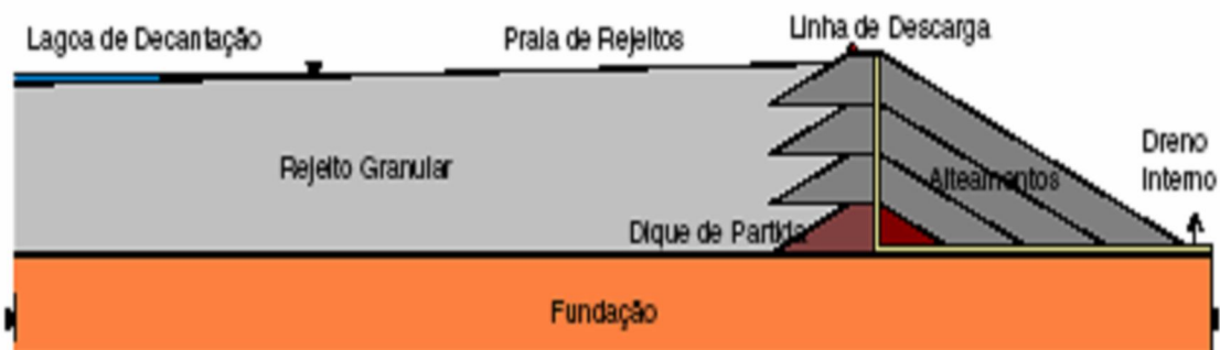
Figura 3.4: Esquema de construção de barragem pelo método linha de centro (ALBUQUERQUE, 2004).
