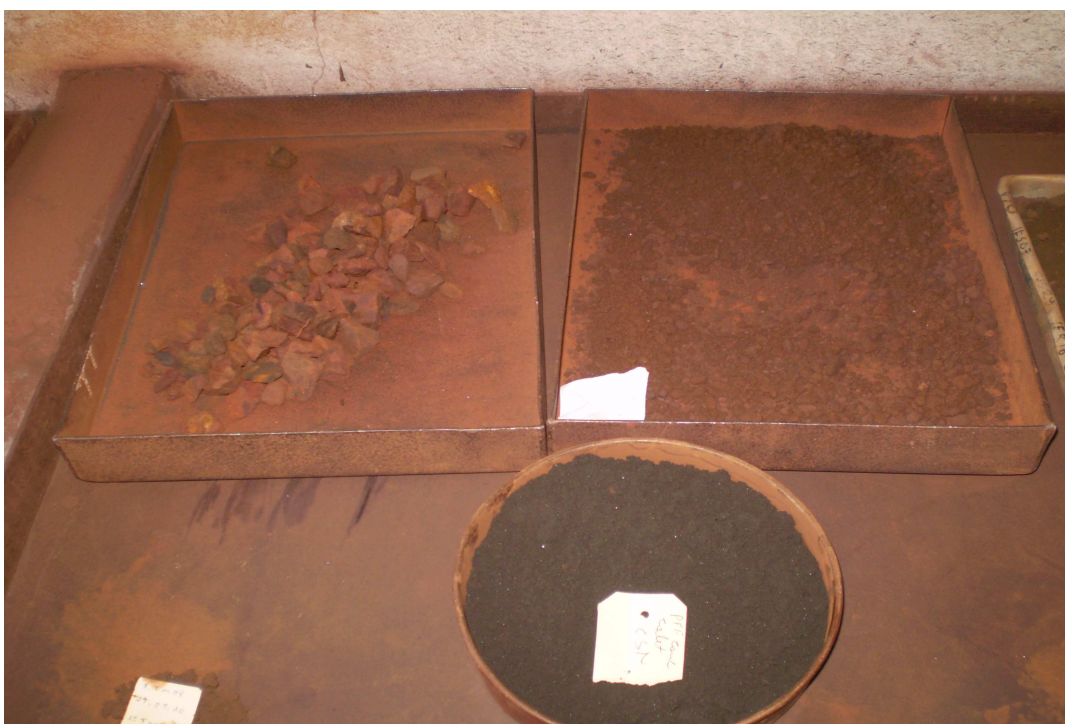
Foto 06: Diferença de cor e granulometria dos produtos: Hematitinha (canto superior esquerdo), Sinter Feed (canto superior direito) e PFF (recipiente circular, parte inferior) (maio/2010).
