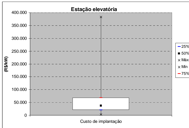
Figura 34 – Custos por kW para implantação de estações elevatórias.
