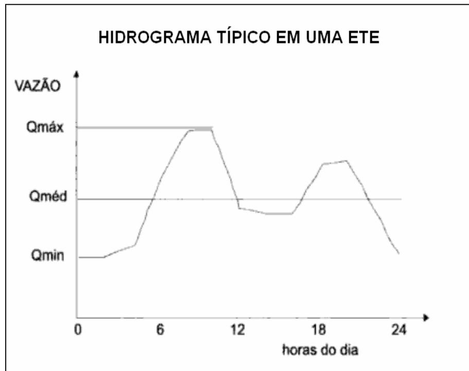
**Figura 5.1** – Hidrograma típico da vazão afluyente de tratamento de esgotos.
