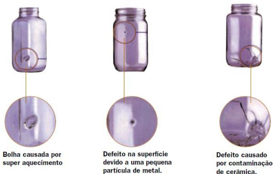
**Figura 3 Defeitos na Fabricação do Vidro**
