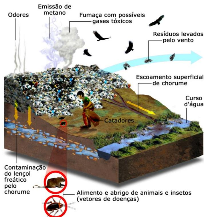
**Figura 3.1** – Figura esquemática de um lixão
