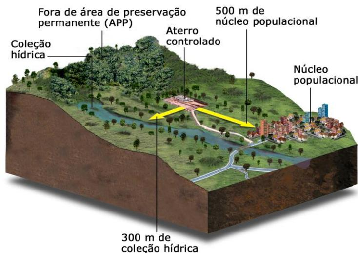
**Figura 3.2** – Figura esquemática de um aterro controlado
