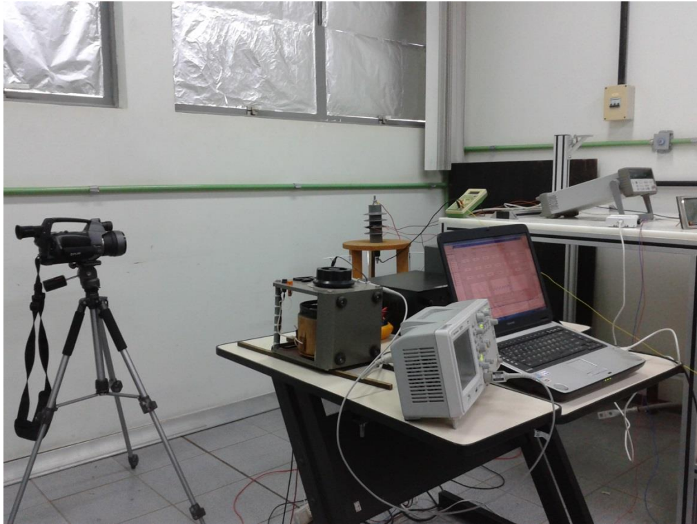
Figura 5.33 - Equipamentos utilizados para a verificação da influência dos parâmetros de aquisição na temperatura medida
