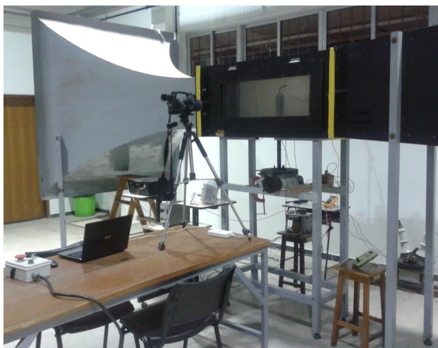
Figura 5.18 - Equipamentos utilizados no experimento sobre a influência da velocidade do vento na temperatura dos para-raios (visão posterior)
