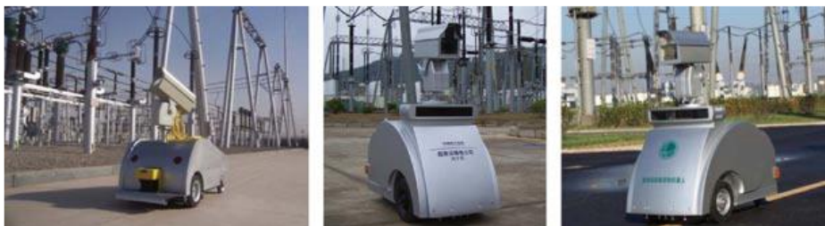
Figura 3.3 - SmartGuard em subestações na China
