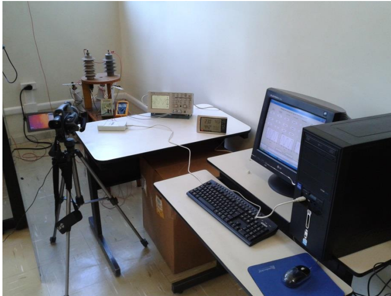
Figura 5.8 - Experimento para verificação da estratégia de extração da corrente resistiva
