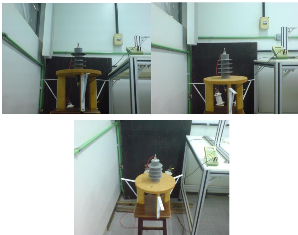
Figura 5.30 - Três posições do para-raios novo submetido à tensão de 11 kV na temperatura ambiente de 25°C
