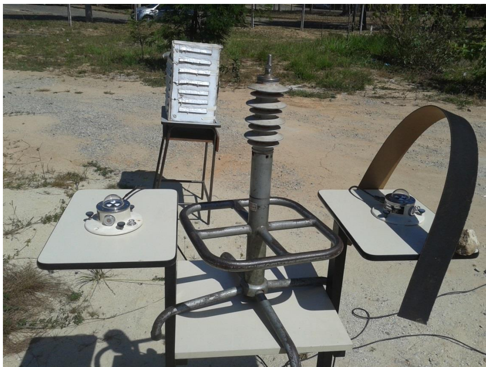
Figura 5.12 - Experimento para determinação da influência da radiação solar na temperatura superficial de um para-raios
