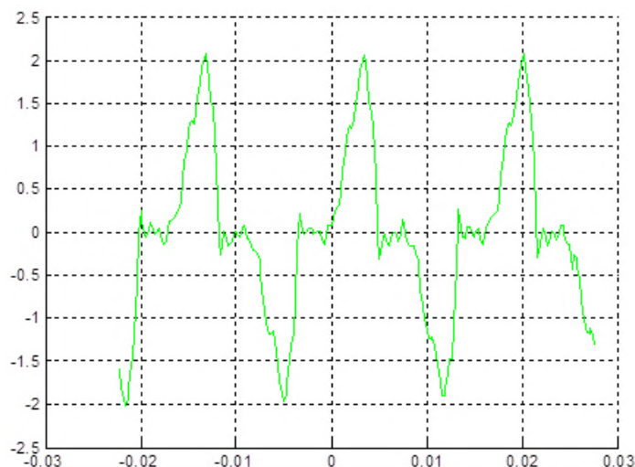
Figura 4.24 - Resultado da extração da corrente resistiva para uma forma de onda não senoidal
