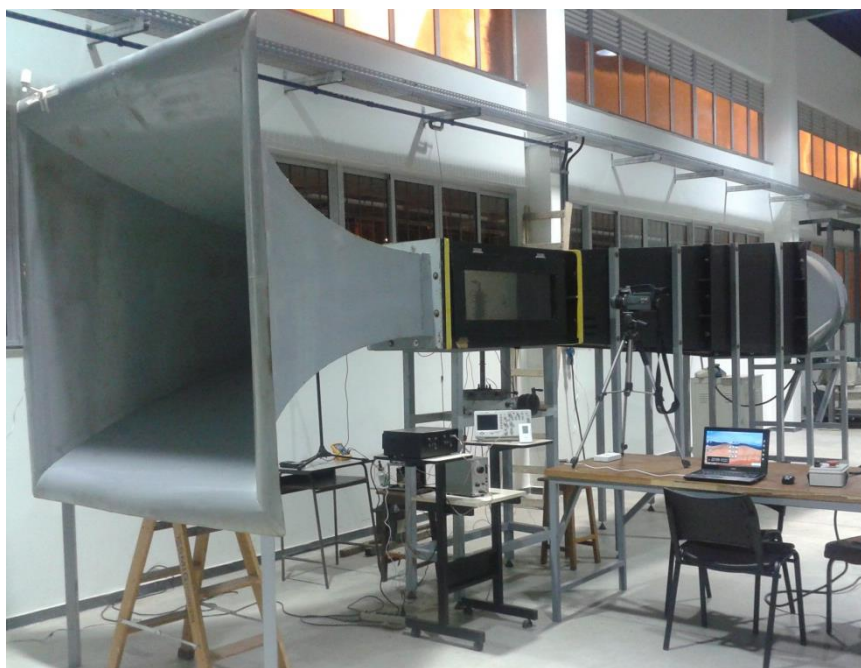
Figura 5.17 - Equipamentos utilizados no experimento sobre a influência da velocidade do vento na temperatura dos para-raios (visão frontal)
