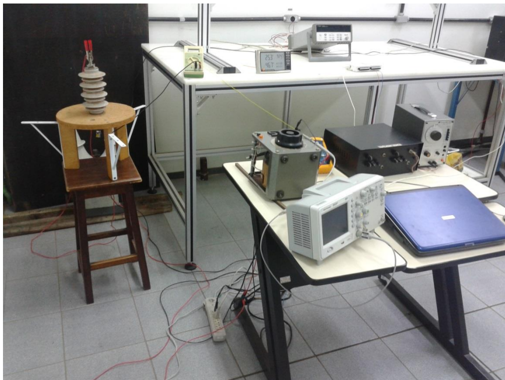
Figura 5.25 - Equipamentos utilizados no experimento sobre a influência da temperatura ambiente na temperatura superficial de para-raios
