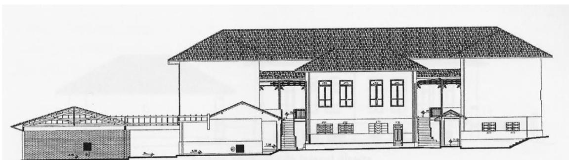
Já as fachadas laterais (figuras 04 e 05) apresentam construção simples, constituídas por painel único em dois níveis sendo o superior vazado por sequências de janelas altas. No porão é possível notar a diferença das tipologias, tendo em vista a manutenção de três janelas originais situadas no lado esquerdo com verga em arco abatido e esquadrias de madeira.
