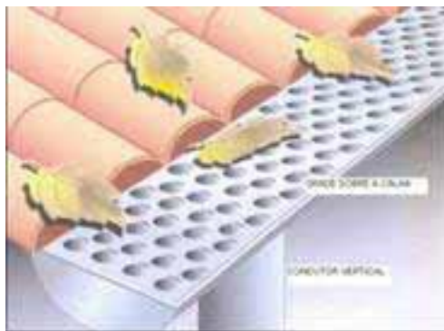
Figura 4.17 – Sistema de grade localizada sobre a calha.
