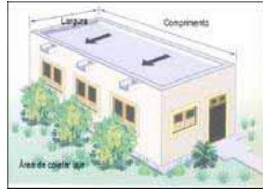
b) Laje impermeabilizada
