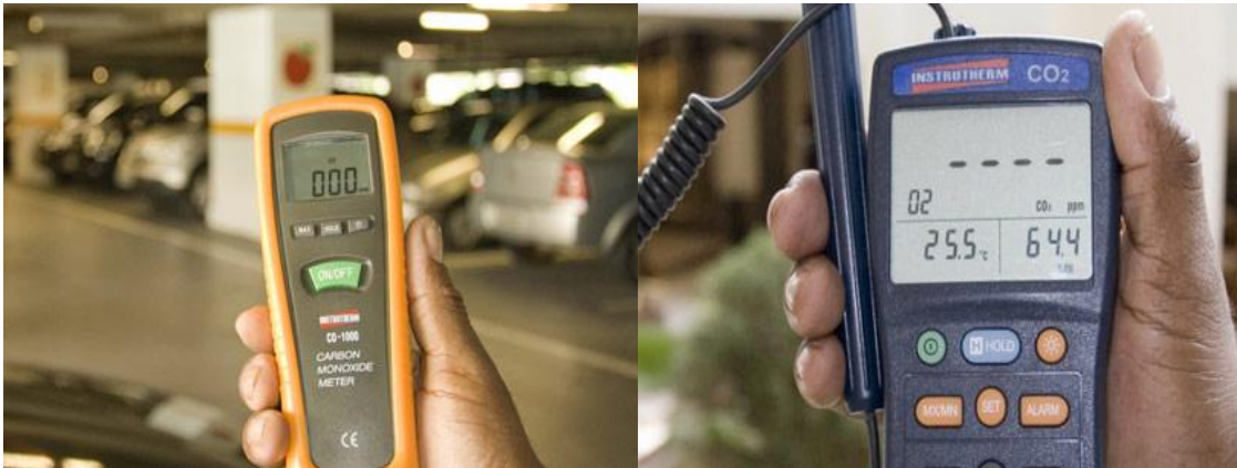
Figuras 11 e 12 : Controle de emissão de CO e CO 2 Fonte: Iguatemi São Paulo (2010)
