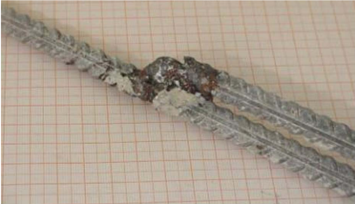
Figura 3.3 – Detalhe da emenda do corpo de prova a) após os ensaios, já sem o concreto em volta (retirado de [9]).
