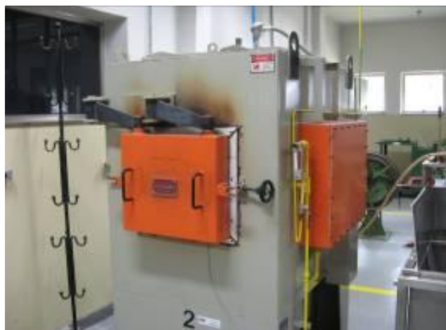
Figura 4.2 – Forno tipo mufla utilizado para realizar o recozimento da BQ.
