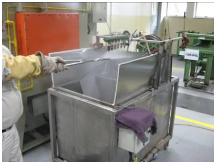
Figura 4.7 – Montagem para a realização do resfriamento ar + água.
