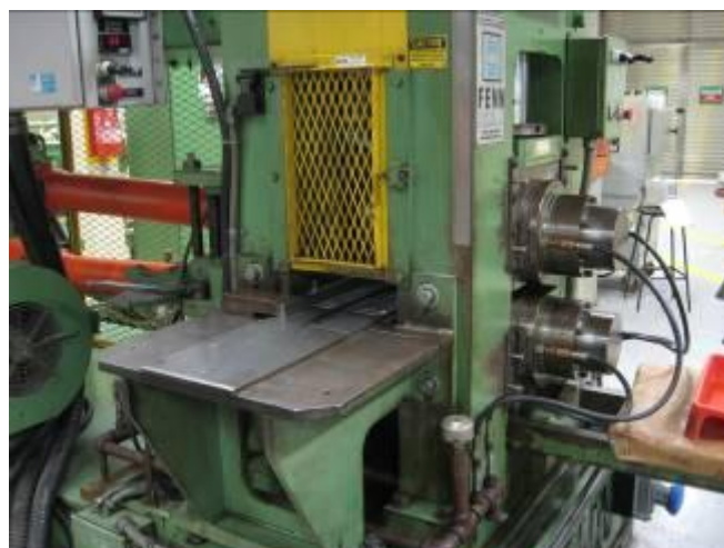
Figura 4.3 – Laminador piloto utilizado para realizar as duas etapas de laminação.
