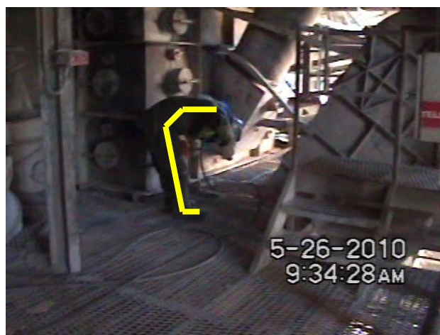
Figura 2 Fotografia do operador realizando limpeza na porta baixa ao nível da plataforma
