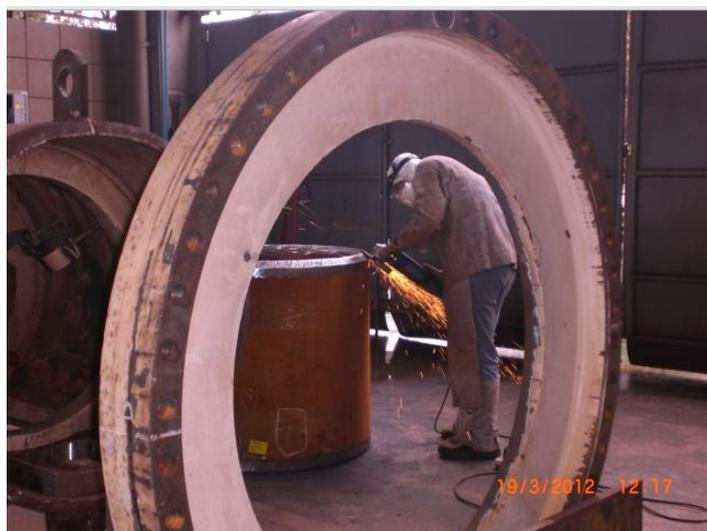
**Figura 9 – Soldador utilizando a esmerilhadeira no processo de acabamento.**
