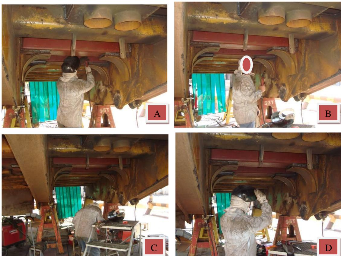
**Figura 6 – Soldador no processo de goivagem na parte superior de uma caçamba de escavadeira. (A) Soldador em pé com ombros flexionados, sem apoio para os braços. (B) Doze minutos depois interrompe para troca de eletrodo e retorna o processo na mesma posição por 33 minutos. (C) Pausa de dez minutos. (D) Após a pausa preparo para reiniciar a goivagem na mesma posição.**
