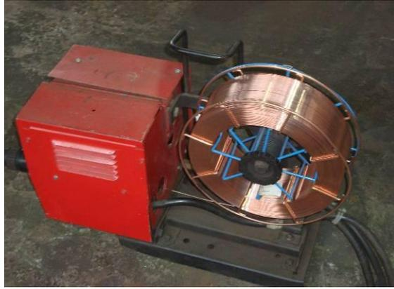
**Figura 4 – Rolo de fio de solda utilizado na soldagem com MIG.**
