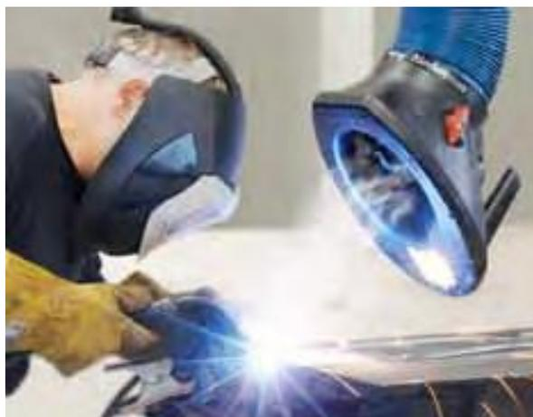
**Figura 13 – Ilustração do sistema de exaustão utilizado em processos de soldagem.**
