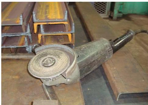
**Figura 5 – Esmerilhadeira utilizada no processo de acabamento da solda.**
