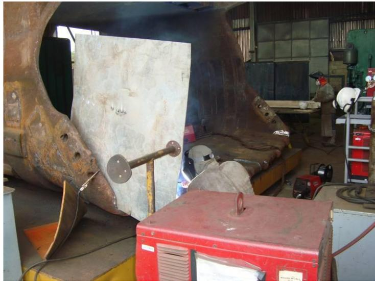
**Figura 10 – Compensado utilizado pelo soldador em processo de soldagem para proteger a solda da corrente de vento.**
