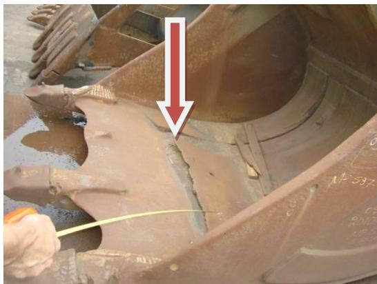
**Figura 12 – Caçamba de retroescavadeira com rasgos e trincas para serem reformados.**
