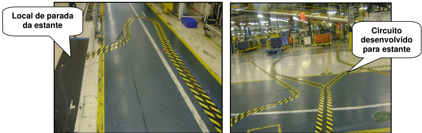
Figura 19 – Imagens de parte de um circuito realizado por uma estante com deslocamento magnético.
