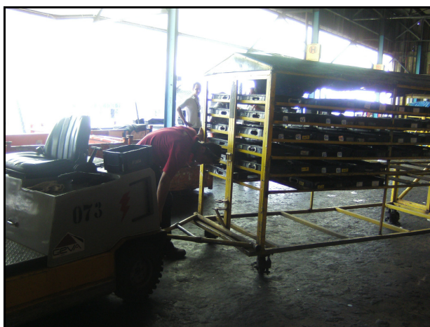
Figura 8 – Fotografia do operador acoplando o eixo da carretinha no rebocador industrial
