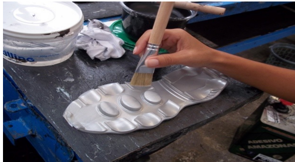
FIGURA 5 – TRABALHADORA UTILIZANDO A BANCADA PARA APOIAR O SOLADO
