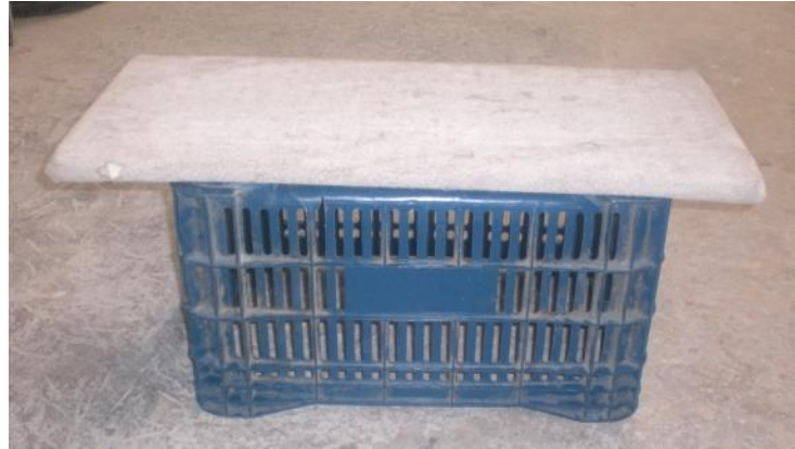
(Figura 10) – Caixote utilizado como regulação para lixar peças grandes.
