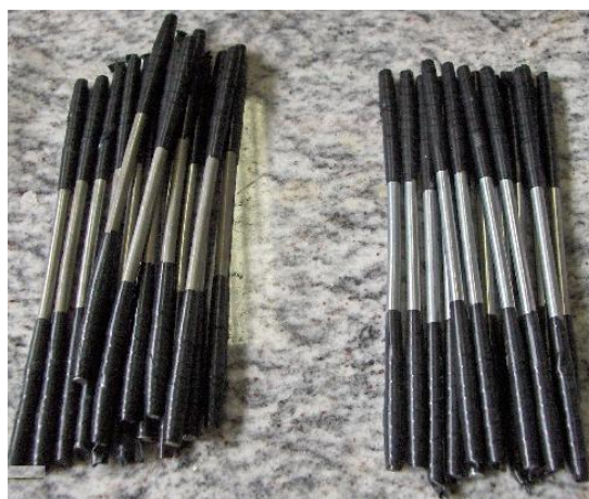
Figura 4.3 – Foto: Armaduras de aço carbono e aço galvanizado.
