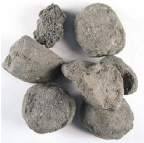
Figura 3.11 – Clíquer para a fabricação do cimento (BASTOS, 2006).
