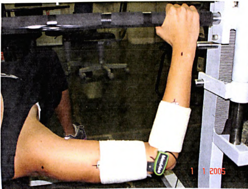
FIGURA 4 – Fixação do eletrogoniômetro e posicionamento na barra guiada.
