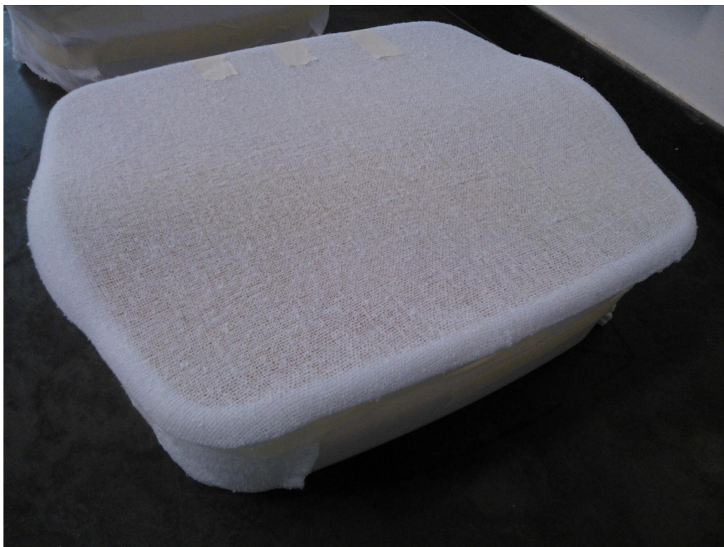
Figura 5 Biorreator (bacia de plástico) no qual foram realizadas as fermentações em escala piloto
