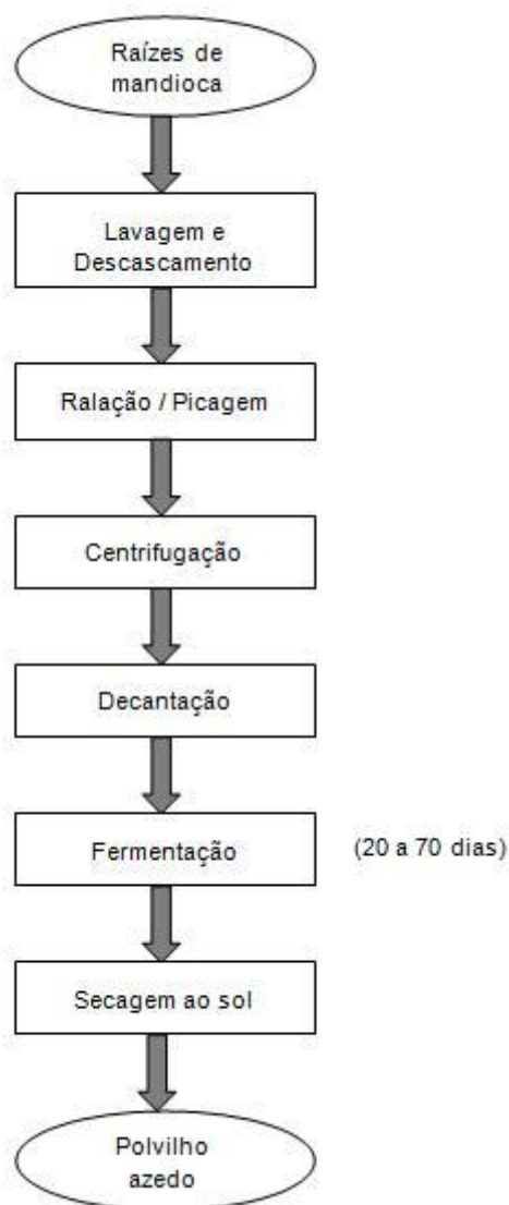
Figura 3 Fluxograma do processamento de raízes de mandioca para a produção de polvilho azedo
