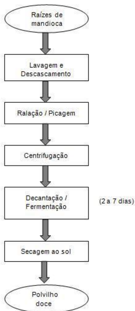
Figura 2 Fluxograma do processamento de raízes de mandioca para a produção de polvilho doce
