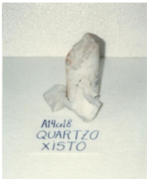
Figura 5.4.2 - Ensaio de compressão uniaxial. Quartzo-xisto (foto).
