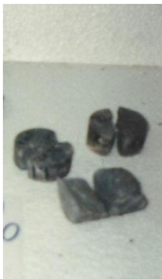
Figura 5.3.9 - Foto de amostra submetida a ensaio brasileiro. Itabirito dolomítico.
