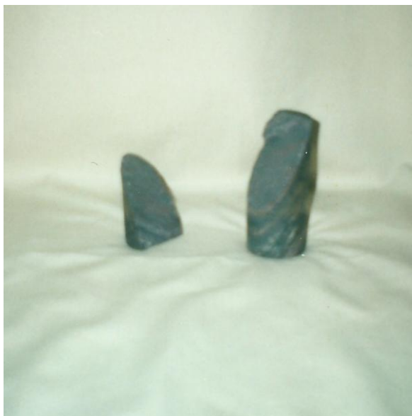
Figura 5.3.8 - Foto de amostra submetida a ensaio de compressão uniaxial (rompeu por cisalhamento).
