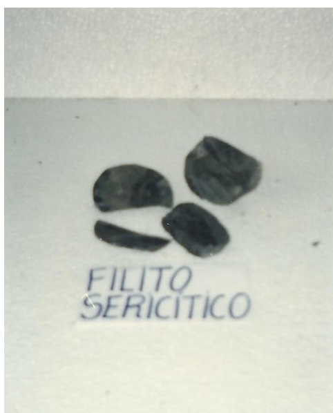
Figura 5.6.5 - Foto de amostra submetida a ensaio brasileiro. Filito sericítico, furo de sonda 03 (1982).
