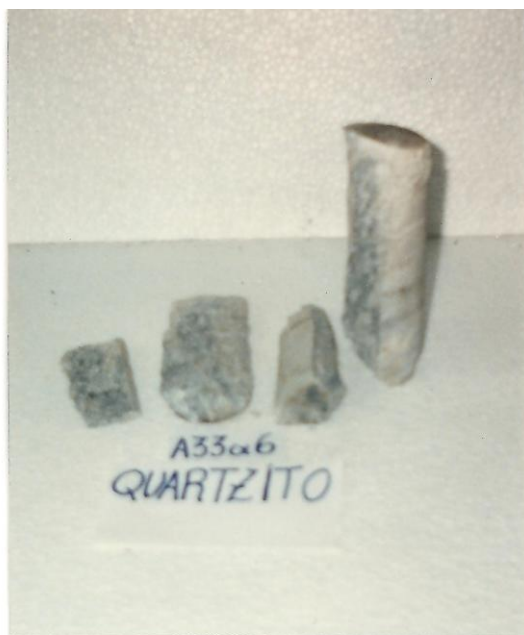
Figura 5.5.6 - Foto de amostra submetida a ensaio de compressão uniaxial. Quartzito, furo de sonda 02 (1985).
