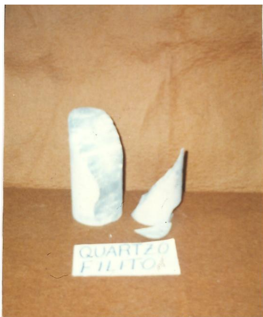
Figura 5.7.1. Ensaio de compressão uniaxial. Quartzo-filito. Foto
