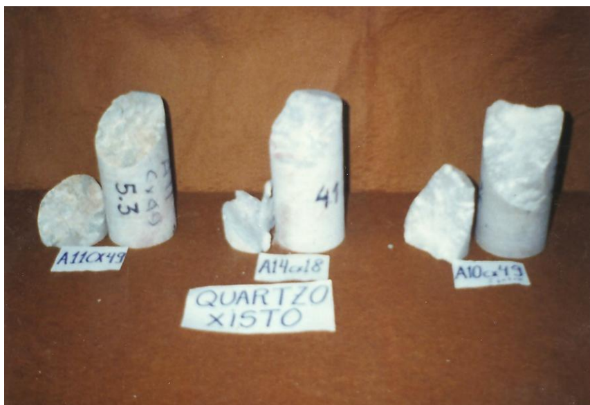
Figura 5.4.1 - Foto de três amostras submetidas a ensaio de compressão uniaxial. Quartzo-xisto.
