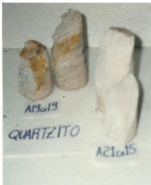
Figura 5.5.1 - Foto de duas amostras submetidas a ensaio de compressão uniaxial. Quartzito, furo de sonda 02 (1982).
