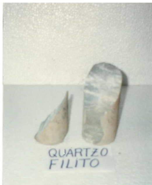
Figura 5.7.2. Ensaio de compressão uniaxial. Quartzo-filito. Foto
